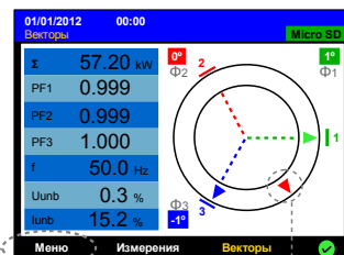
Пример контроля типа соединения
